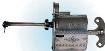
Рис. 2.8. Ручная бормашина с заводным устройством
