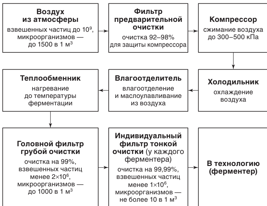
Рис. 2.6. Технологическая схема очистки и стерилизации воздуха
