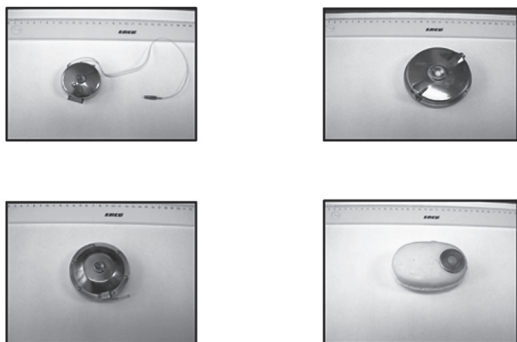
Рис. 1.4. Имплантируемые дозаторы инсулина, разработанные в 1987–1990 гг.
