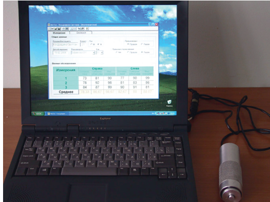
Рис. 9.35. Датчик аналогового миотонометра, подключенный к компьютеру
