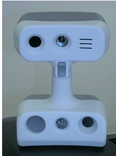
Рис. 9.1. Трехмерная оптическая видеокамера Broadway 3D
