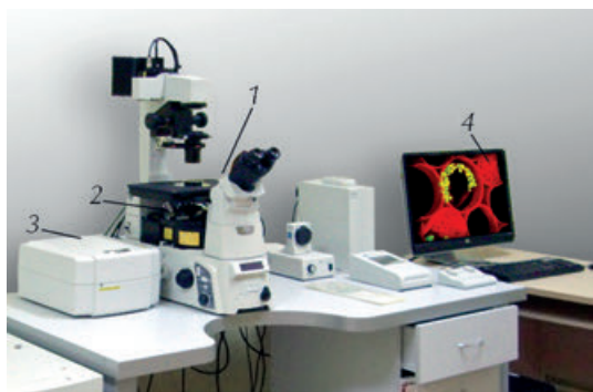
Рис. 1.6. Конфокальный микроскоп: 1 — световой микроскоп; 2 — объективы; 3 — блок управления сканирующим устройством для перемещения светового луча по оси X, Y, Z; 4 — цифровое изображение после обработки с помощью программы компьютера
